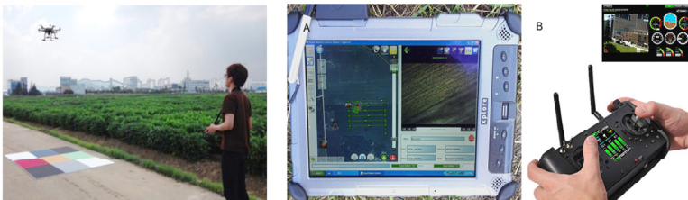
그림 3-15 드론 비행 모습(좌)과 비행 워크스테이션과 무선 조종기(우)
