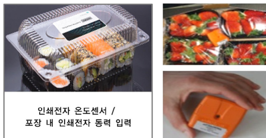
그림 10-20 바이오 센서가 통합된 수동형(좌)과 능동형(우) RFID 적용 사례
