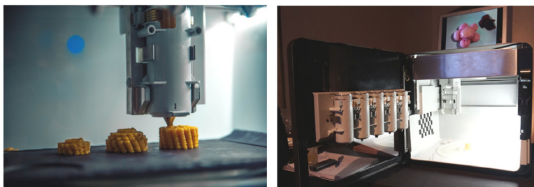
그림 8-7 푸디니의 출력모습(좌)와 오픈 캡슐 시스템(우) 12)
