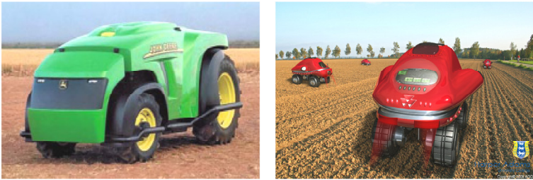
그림 3-29 미래 농업용 자율주행 로봇(좌)과 소형 플랫폼 기반 농작업 로봇(우)
