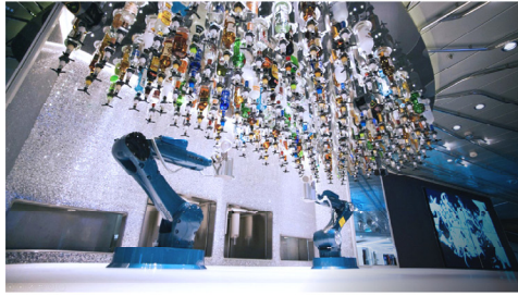
그림 7-7 Robotic Bar System의 2개의 로봇 팔이 고객의 주문을 받아서 칵테일을 만들어 제공한다 10)
