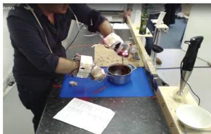
그림 7-5 Moley Robotics사의 셰프 로봇은 motion-capture technology (인간의 움직임을 캡처)를 통해서 요리 동작을 사전에 학습한다 8)
