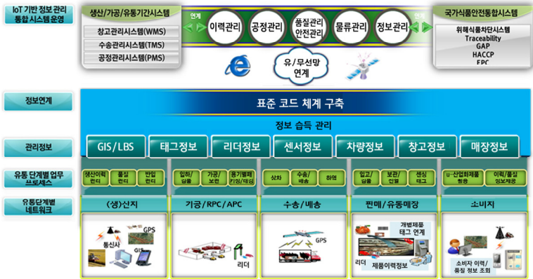
그림 9-11 IoT기반 차세대 지능형 식품유통 시스템
