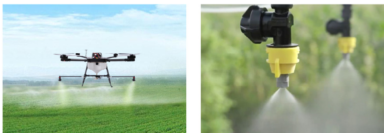
그림 3-21 농약살포에 사용되는 드론과 살포노즐의 모습
